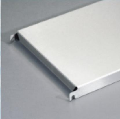
Die Geschlossenen Auflagen sind aus Chromnickelstahl 18/10, Werkstoff 1.4301 gefertigt, an der Längsseite 40 mm und an der Stirnseite 30 mm abgekanzelt und nach innen gefalzt.
