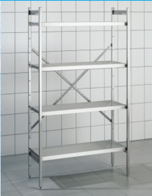
Standregal Norm 5, Grundregal bestehend aus 2 Regalständern, 1 Kreuzstrebe und 4 Auflagen. Die Regalständer sind aus Chromnickelstahl 18/10, Werkstoff 1.4301, gefertigt. Die Querverbindungen aus Flachprofil werden nach einem hochmodernem und patentierten Verbindungsverfahren formschlüssig in die Ständerholme integriert - für höchste Stabilität. Lieferbar sind Regalständer für 600 kg und 1200 kg Feldlast.
